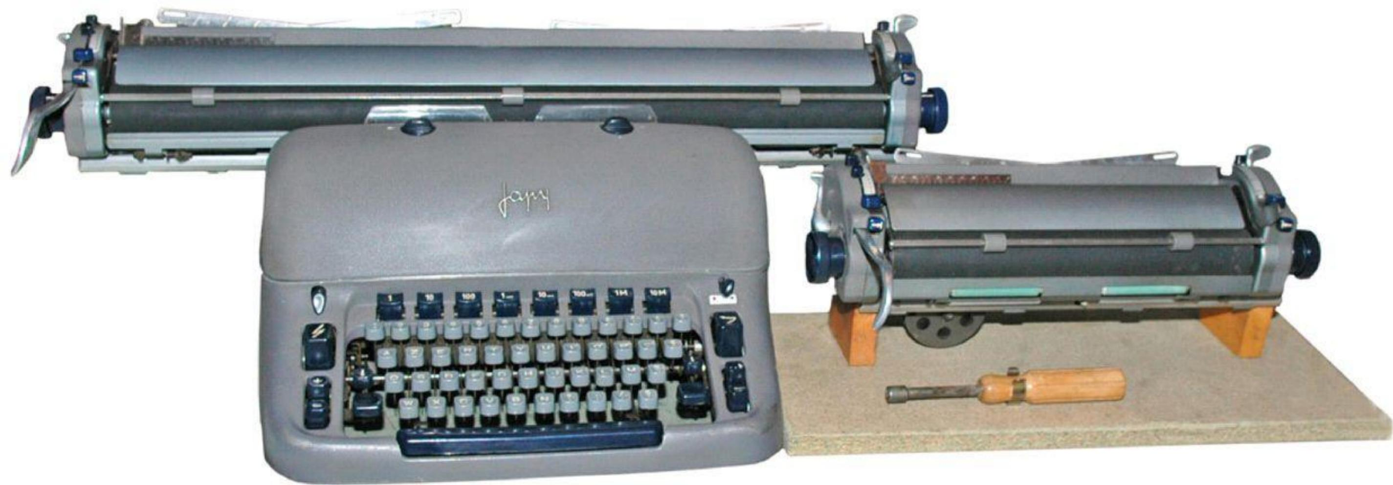
***Machine bi chariots 29 et 63cm avec frein centrifuge (Licence Paillard)***
