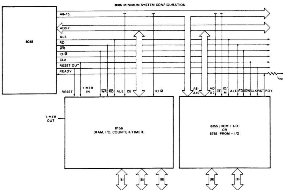
FIGURE 4. MCS-85™ MINIMUM SYSTEM (MEMORY MAPPED I/O)
