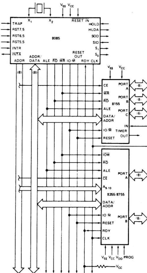
FIGURE 3. 8085 MINIMUM SYSTEM (STANDARD I/O TECHNIQUE)
